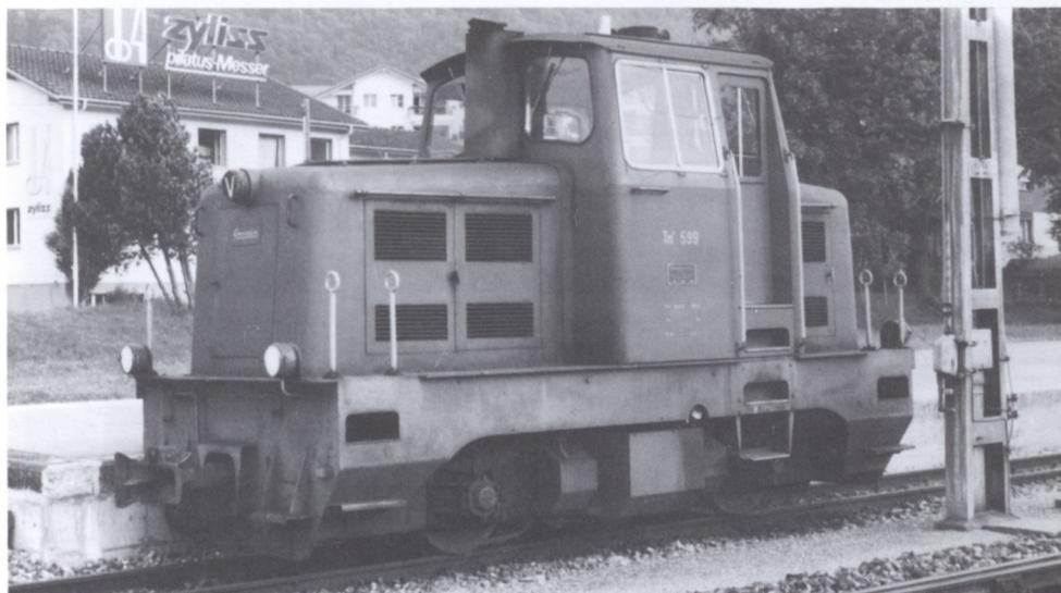
angepasst und erhielt u.a. einen neuen Saurer-Dieselmotor des gleichen Typs, wie ihn auch die normalspurigen Tm III aufweisen. Dieser 1957 erbaute Traktor hätte ursprünglich mit der Nummer 9961 oder 991 versehen werden sollen.
