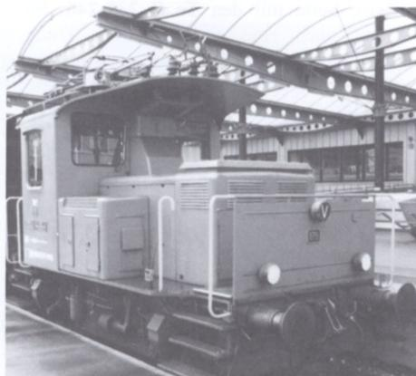
Einer der wenigen Stationstraktorentypen ohne Kuppelstangen: Te III 179 am 13.11.94 in Vevey (Foto M. Klausner)
